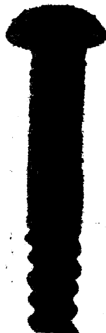
شکل ۷- ۱۸ نقش پراش و سایه فرنل برای یک بیچ
