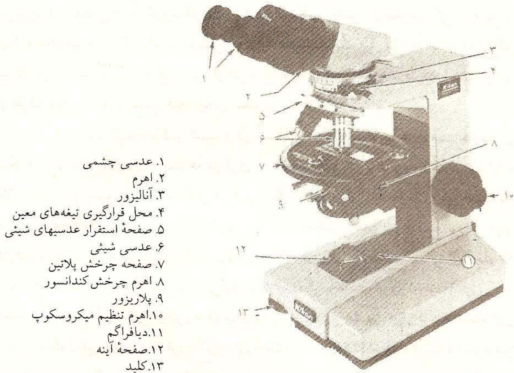
نمایش قسمتهای یک میکروسکوپ پلاریزان
