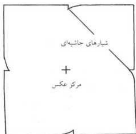
شکل ۱۹-۲ پیدا کردن مرکز عکس با استفاده از شیارهای حاشیه‌ای
