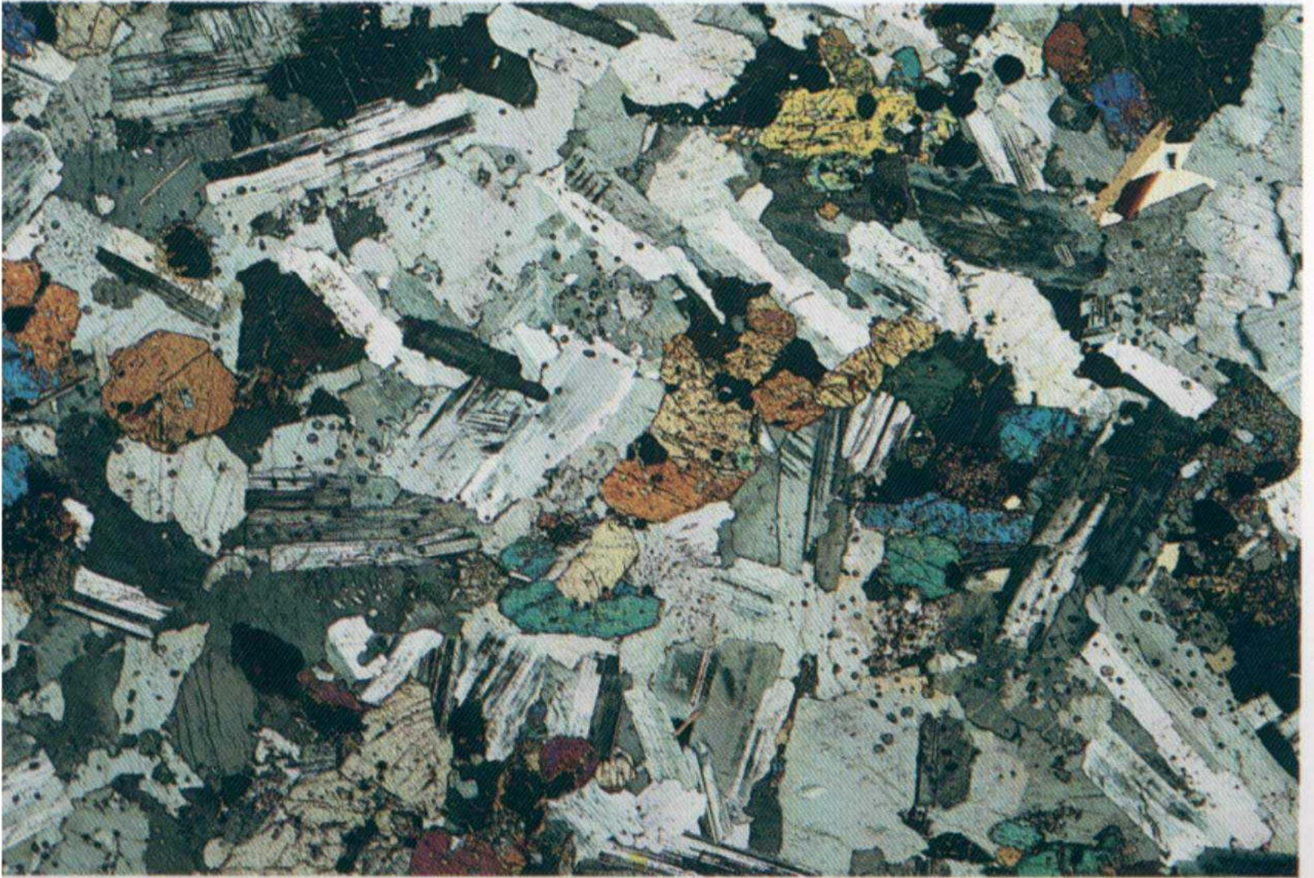
مقطع میکروسکپی یک مونزونیت
