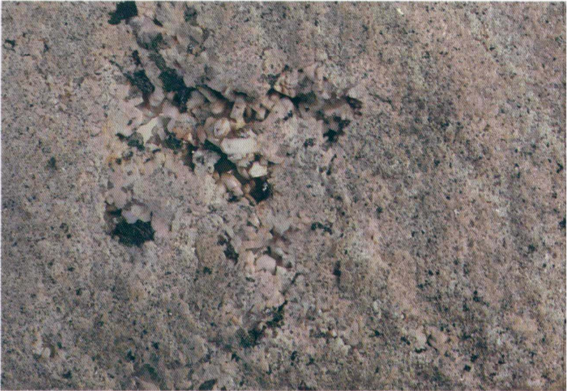
حفرات میارولیتی در یک نمونه گرانیتی
